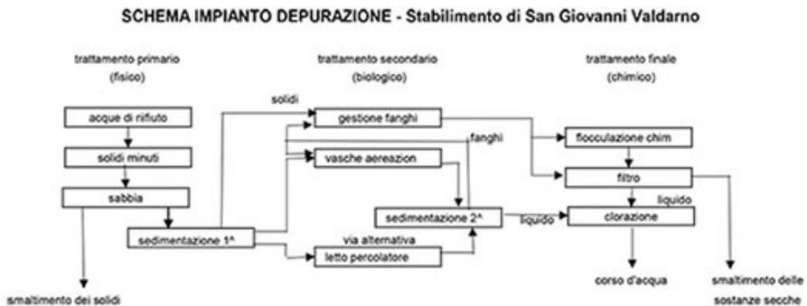
*Fig. 71 Processo trattamento Ecologico delle acque reflue*
