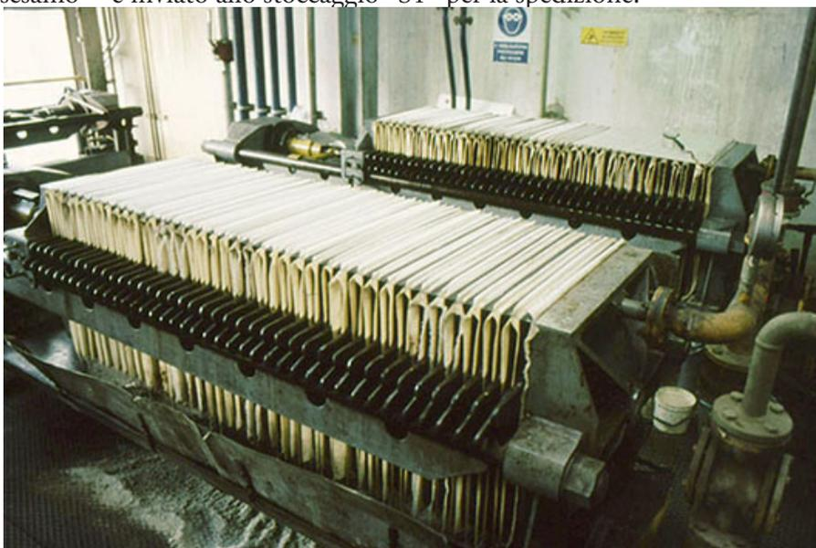
*Fig.50 Filtro pressa con teli filtranti*
